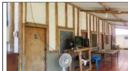
Alojamiento de estudiantes: Se trata de una edificación de un piso, construida por el sistema de muros portantes en ladrillo, pisos en cerámica, muros en pañete, estuco y pintura, cubierta en teja fibrocemento, sobre cerchas de guadua.
